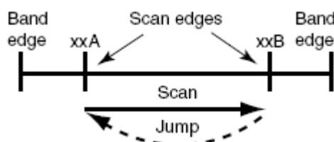
在用户自定义的 2 个频率之间反复扫描，可以在一个特定的频率范围内检测频率，比如中继台的发射频率，等。
