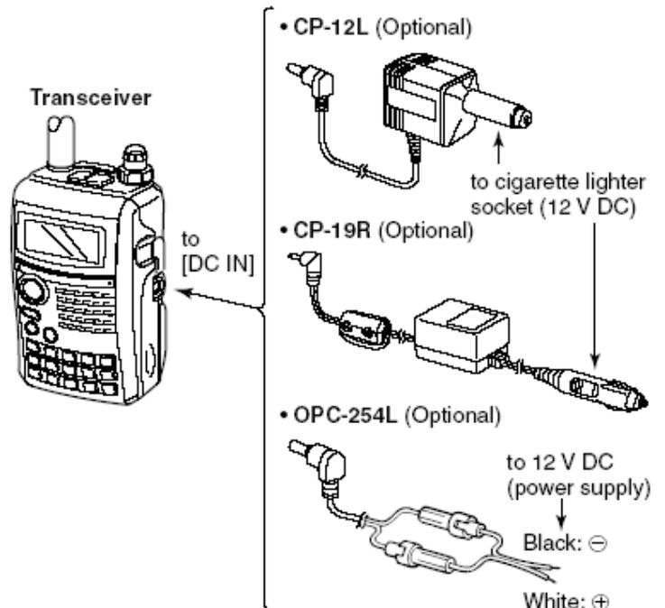
当使用 24 伏电源时，请使用直流转直流的变压器。
