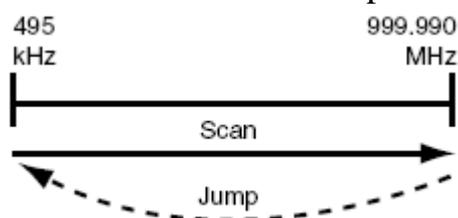
在整个波段进行扫描，根据电台的版本不同，某些频率可能无法包括。
