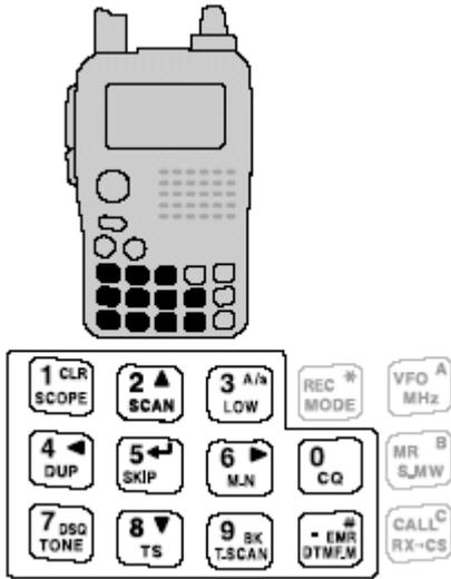
由于频率步进设置不同，KHz 的个位数字位可能无法输入，在这种情况下输入 0 作为个位数字，旋转 [DIAL] 键，选择想要的频率。
