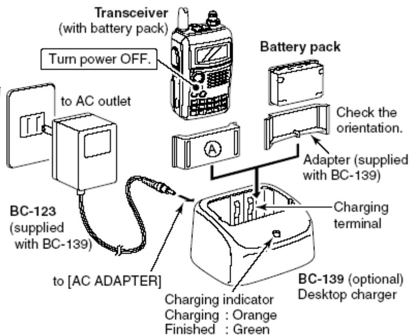
将电池取下独立充电，或者不取下电池将对讲机关闭，否则将不能充电。（BC-139 上的指示灯闪烁橘黄色。）
