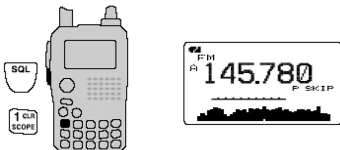
在声音设置模式下，频谱扫描时接收到的声音可以设置为静音。请看 102
