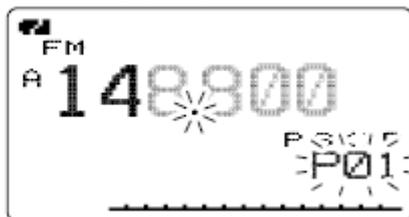
///关于扫描步进：在 VFO 模式下所设定的各波段的扫描步进，就是扫描时的扫描步进。
